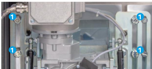
1. Die vier Sechskantschrauben (1) an der Konsole werden leicht gelöst, damit die Getriebeeinheit inkl. Zahnrad von den Gasdruckfedern nach oben gedrückt werden kann. Zahnrad und Zahnstange sollten dabei ineinandergreifen.
